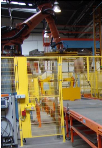
Rys. 1. Otworzenie drzwi w wygradzeniu robota powoduje otwarcie styków łącznika K i zablokowanie ruchu niebezpiecznego
