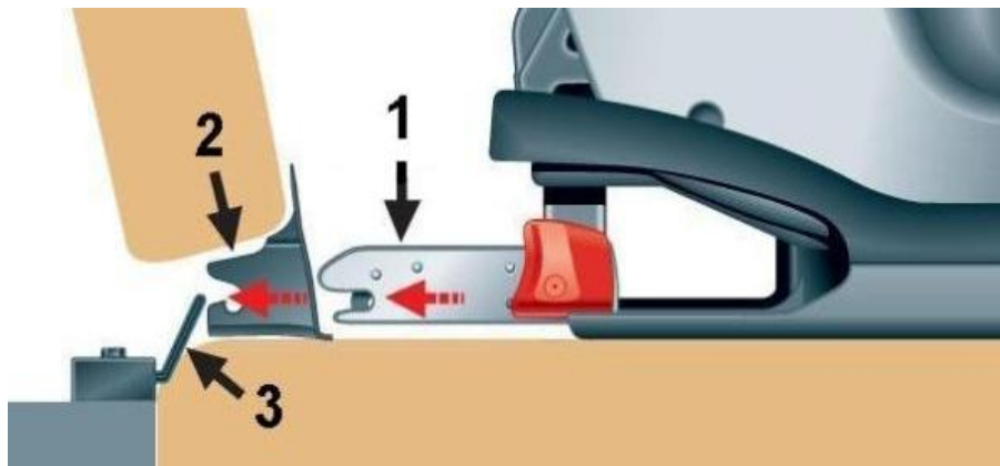
Rys. 1. System ISOFIX - rysunek poglądowy; (1) - zaczep ISOFIX, (2) - wkładka pilotująca, (3) - uchwyt ISOFIX [11].
