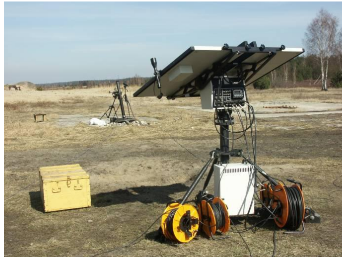
Fot. 7. 98 mm moździerz M-98 i zestaw do pomiaru parametrów balistycznych.
