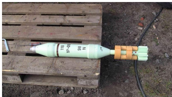
Fot. 5. Nabój moździerzowy z pociskiem dymnym przygotowany do strzelania.
